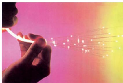
一根细细的光纤电缆能在同一时刻传送4万个数字化电话。
